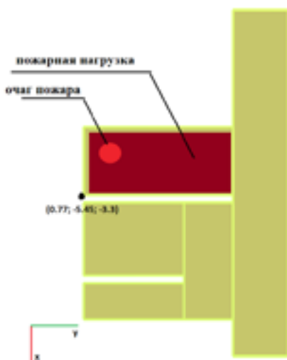
Рис. 2. Схема расположения пожарной нагрузки и очага пожара. Цокольный этаж
