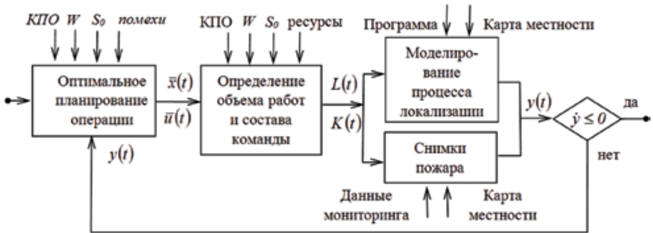
Рис.1. Структурная схема системы оптимального управления противопожарными силами и средствами
