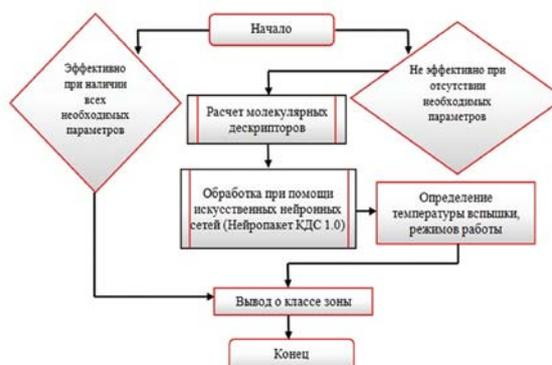
Рис. 2 Усовершенствованный алгоритм определения класса зоны
