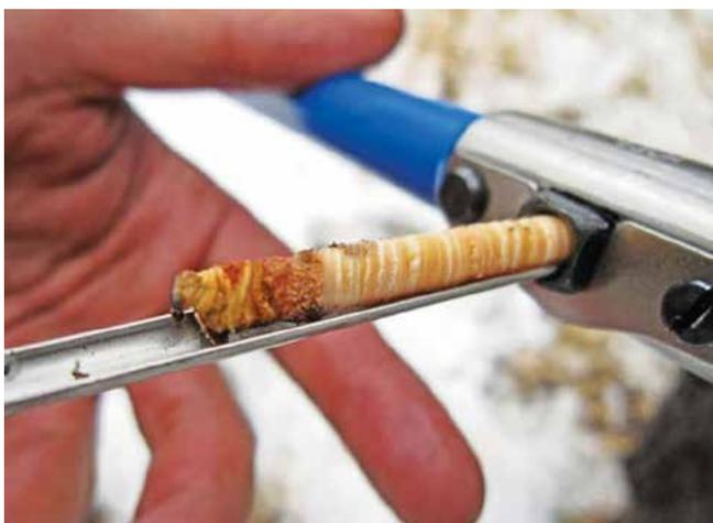
Рис. 2. Извлечения керна с линейкой годовых колец из ствола сосны
