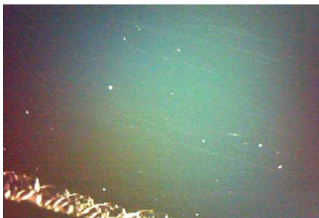
Фото 2. Межмолекулярные связи в стекле не повреждены, ионы остались на прежних позициях (20х кратное увеличение)
