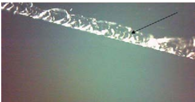
Фото 3. Кромка стекла, образовавшаяся в результате механического разрушения при 50х кратном увеличении
