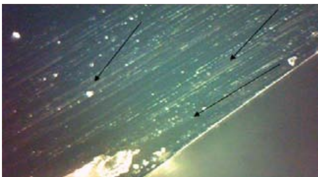
Фото 5. Разрыв химических связей (показано стрелками) в стекле при высокотемпературном воздействии (50х кратное увеличение)
