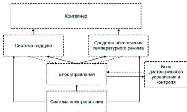
Рис. 1. Структурная схема транспортировочного контейнера
