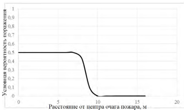
Рисунок 9 - Зависимость условной вероятности поражения человека волной давления от расстояния до очага пожара
