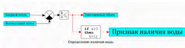
Рис. 4. Схема технологической операции «Заполнение бака» в среде визуального моделирования SimInTech
