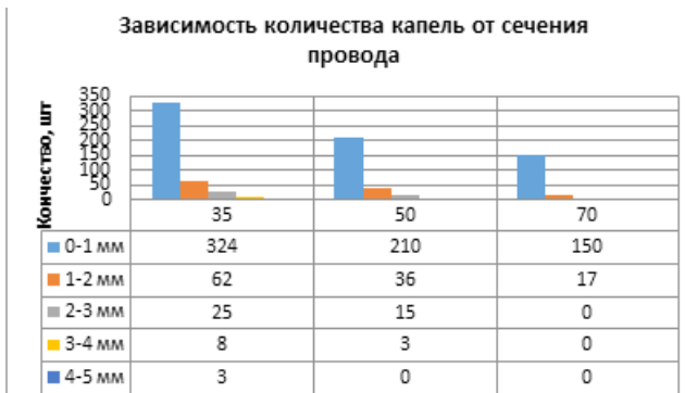
Рис. 5. Зависимости количества и размера капель от сечения провода
