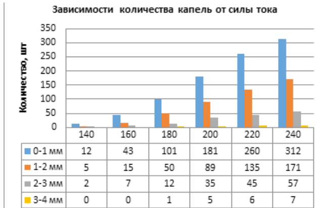
Рис. 4. Зависимости количества и размера капель от тока короткого замыкания
