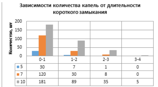
Рис.6. Зависимости количества и размера капель от длительности короткого замыкания
