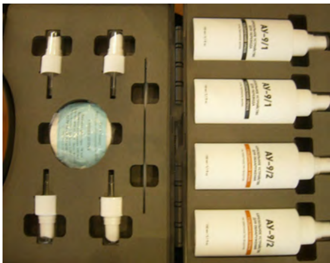
Рис. 3. Модуль № 2 для обнаружения соединений урана в раскрытом положении
