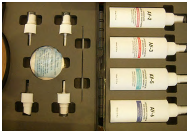
Рис. 2. Модуль № 1 для обнаружения агрессивных веществ в раскрытом положении
