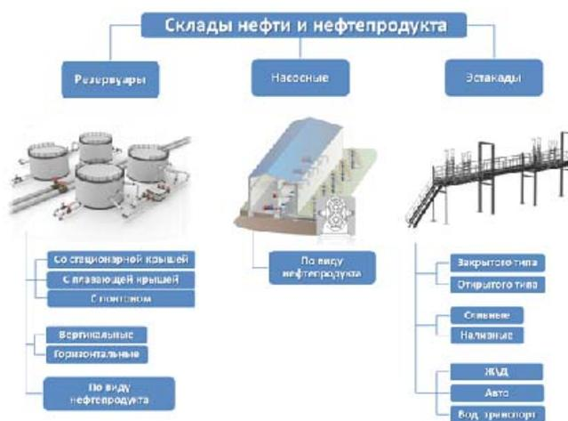
Рис. 1 – функциональная структура складов нефти и нефтепродукта
