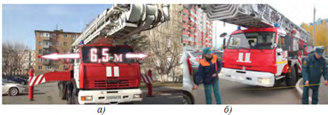
Рис. 1 - Высотная пожарная техника [3-4]: а) минимальная ширина установки автомобиля; б) замер ширины проезда пожарной техники сотрудниками государственного пожарного надзора
