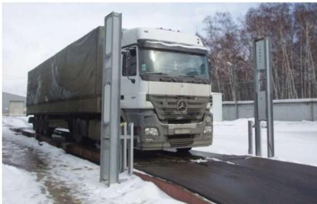
Рис. 1 - Система дозиметрического контроля транспорта с сырьем
