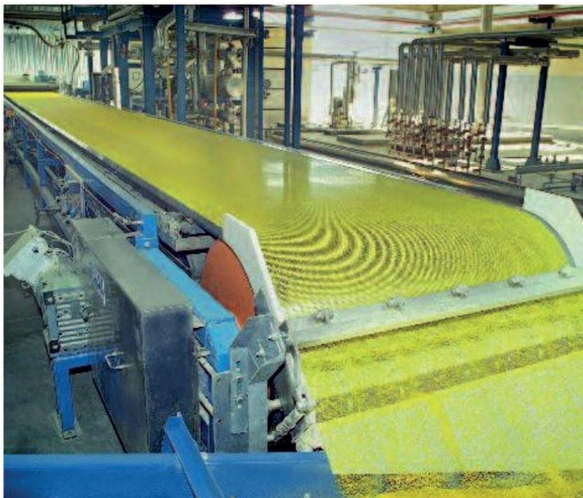
Рис.4. Разгрузочный узел блока грануляции.
