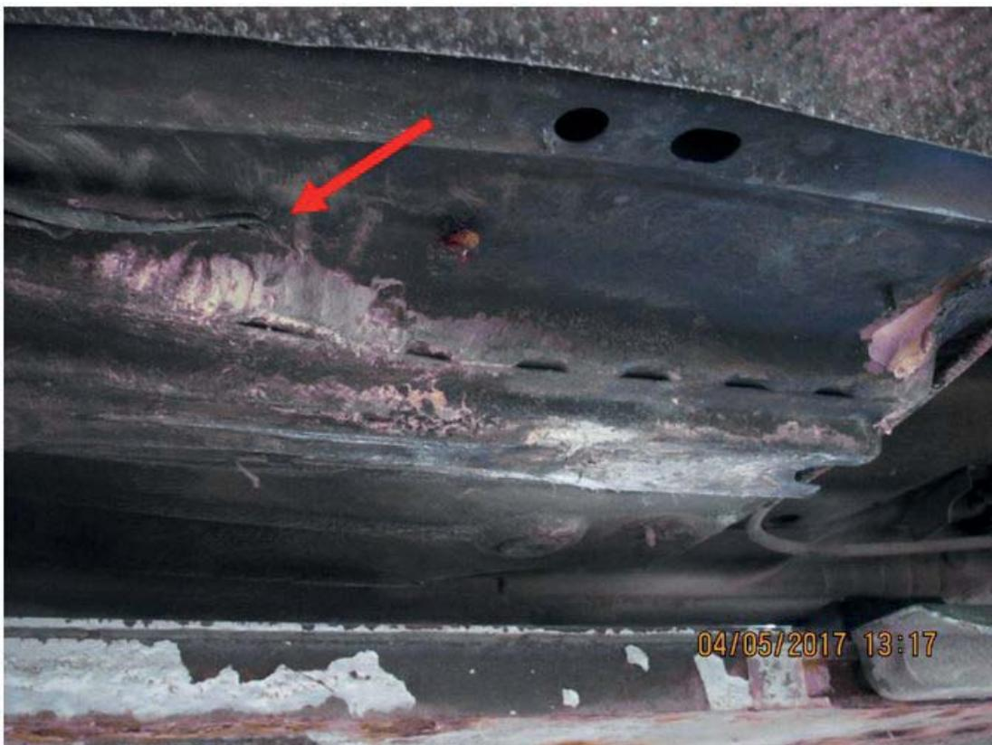
Рис. 2. Зона горения в автомобиле Ford Mondeo. Стрелкой показан район разгерметизации топливной системы
