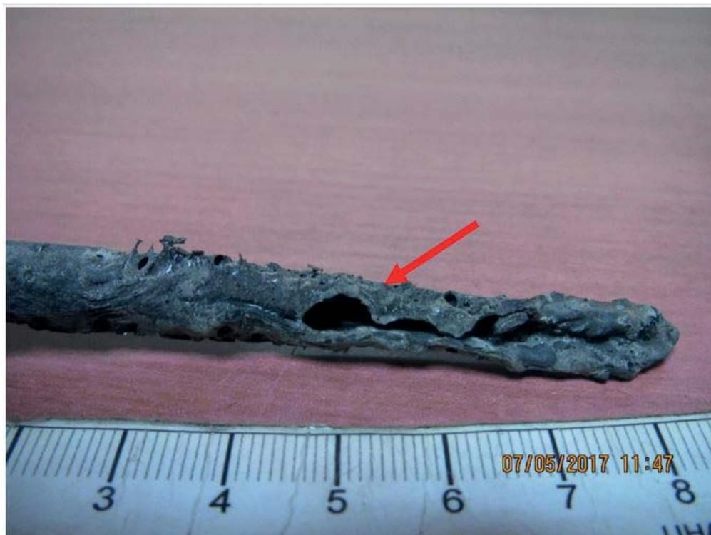
Рисунок 3 — Пример разрушения топливной магистрали
