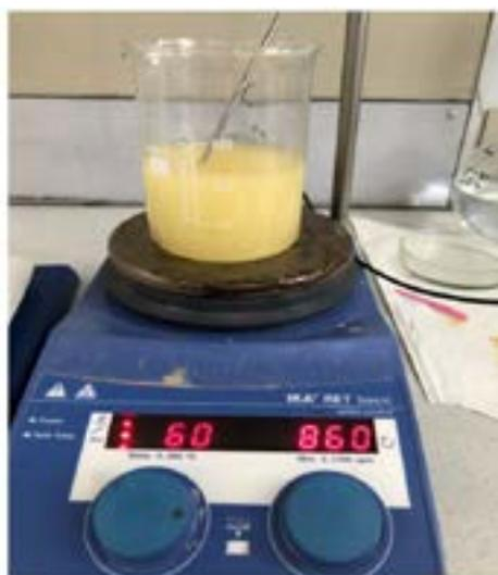
Рис. 4. Смесь деградированного ТБФ с азотной кислотой при второй стадии гидролиза
