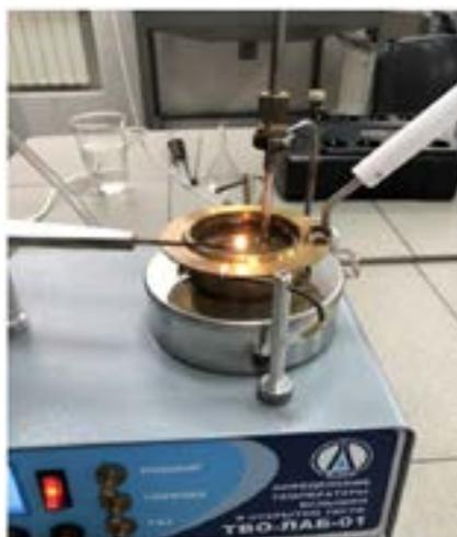
Рис. 1. Прибор для определения температуры вспышки ТВО-ЛАБ-01
