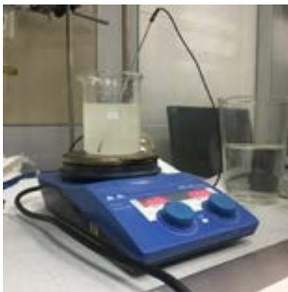
Рис. 2. Первая стадия гидролиза ТБФ азотной кислотой
