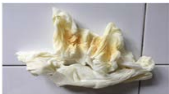
Рис. 6. Образец салфетки, изготовленной из вискозы с добавлением полиэстера, обработанный подсолнечным маслом «Янта», после температурного воздействия
