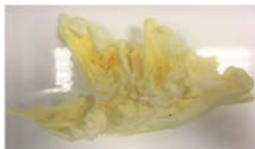
Рис. 7. Образец салфетки, изготовленной из вискозы с добавлением полиэстера, обработанный льняным маслом «Вологодское» с истекшим сроком годности, после температурного воздействия
