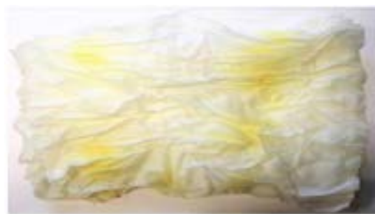
Рис. 4. Образец салфетки, изготовленной из вискозы с добавлением полиэстера после температурного воздействия
