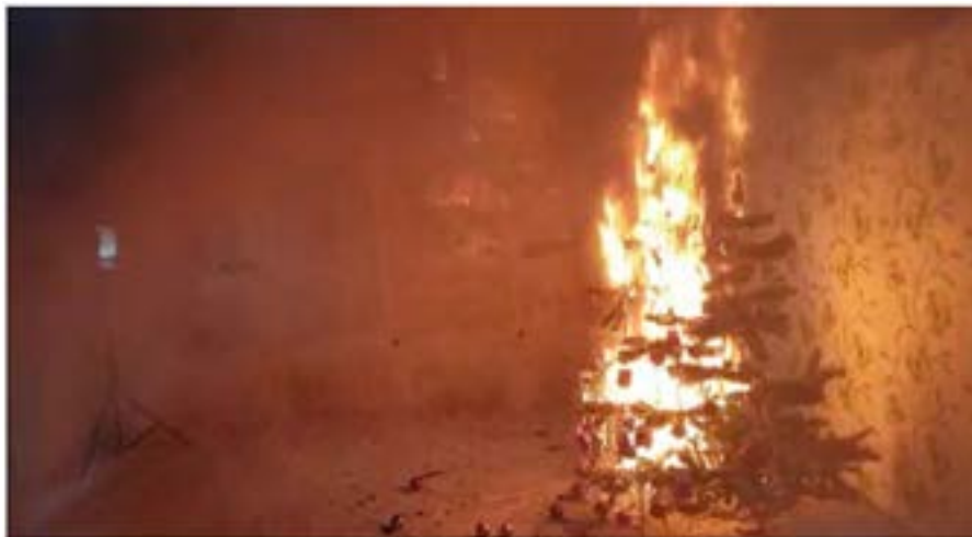
Рис. 3. Пламенное горение ели на двадцать первой секунде от возникновения КЗ
