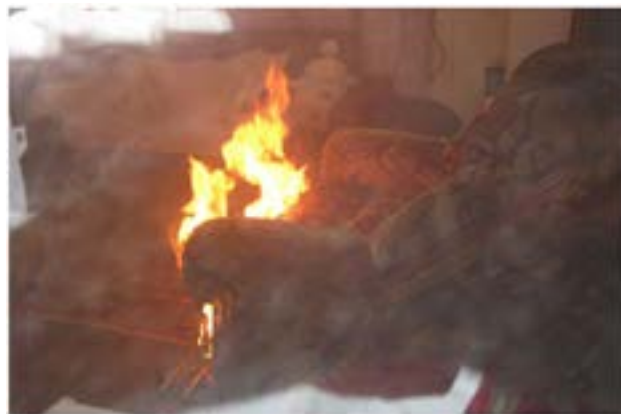
Рис. 5. Открытое пламенное горение, наблюдаемое через 37 минут от начала эксперимента
