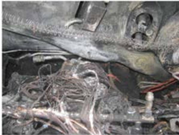
Рис. 2. Зона разгерметизации топливной системы
