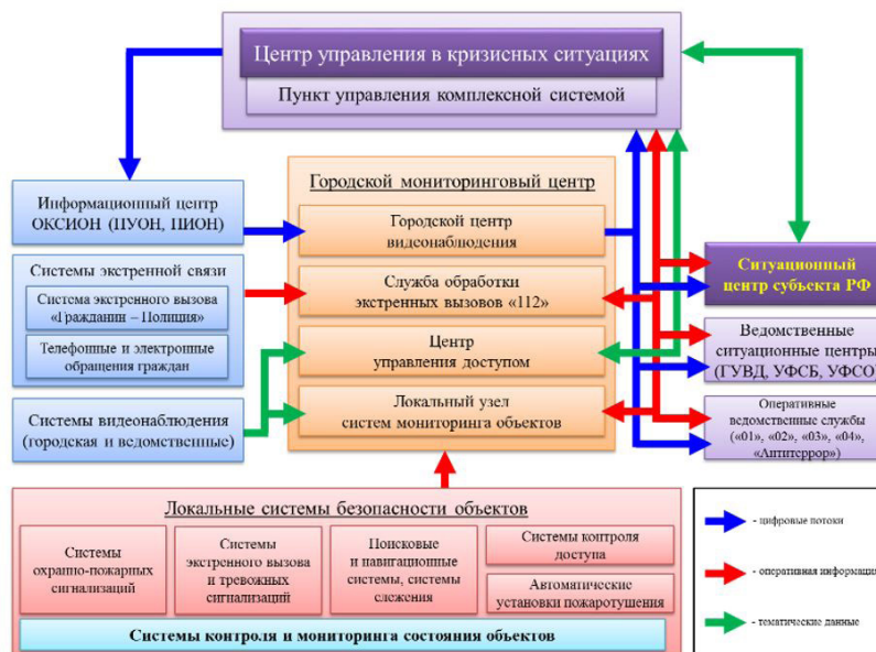
Рис.1. Схема организации управления и взаимодействия в комплексной системе обеспечения безопасности жизнедеятельности населения
