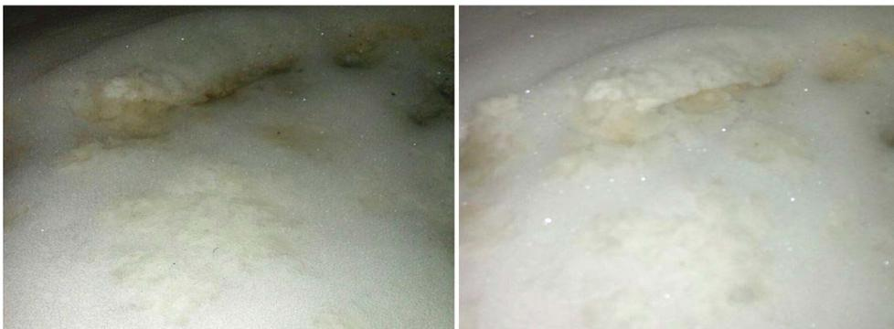
Рис 1. Появление на поверхности пены слоя оксида кремния
