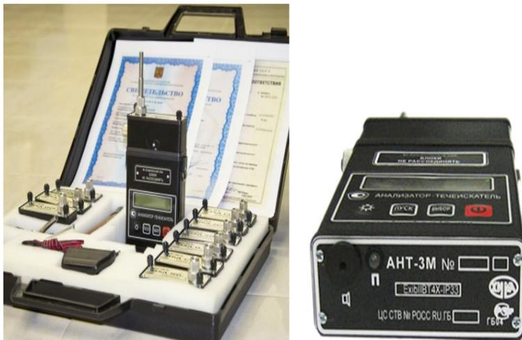
Рис. 5. Фотоионизационный газовый детектор АНТ-3М
