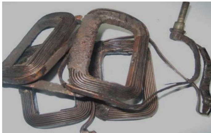
Рис. 8. Оплавление обмотки ротора
