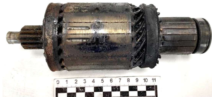
Рис. 7. Локальные термические повреждения электродвигателя стартера
