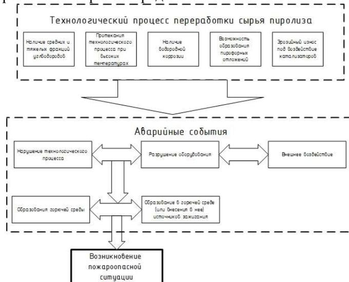
Рис. 2. Основные типовые события, которые могут привести к пожароопасной ситуации на объектах газохимической переработки
