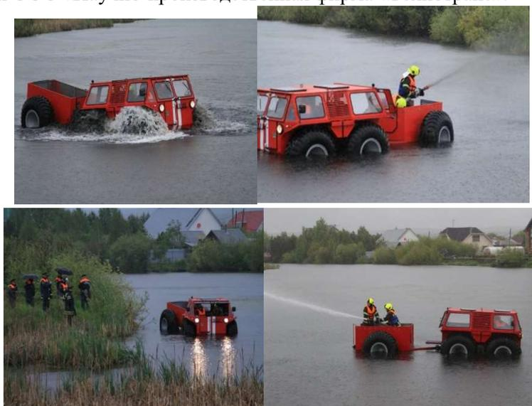
Рис. 6. Снегоболотоход «Феникс ШС-04-02» на испытаниях в условиях болотистой местности
