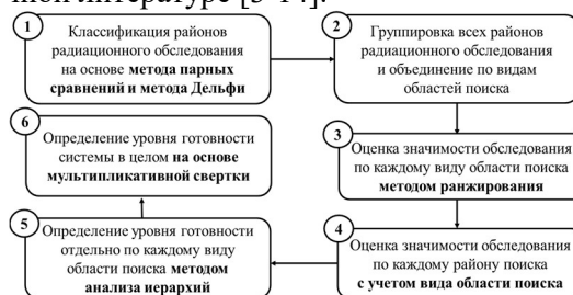
Рис. 4. Последовательность выполнения методики оценки готовности системы мониторинга радиационной обстановки для обнаружения локальных источников ионизирующего излучения
