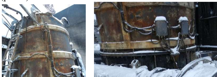
Рис. 6. Корпус бака реактора с термическим повреждениями
