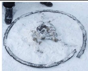
Рис. 9. Сплав из металла белого цвета у реактора фазы С
