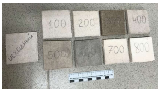
Рис. 4. Образцы после обжига в муфельной печи (примечание: цифрами обозначены температурные значения для обжига в °С)
