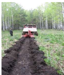
Рис. 1. Опорные полосы, выполненные плугом ПКЛ-70-2 на тракторе ТТ-4
