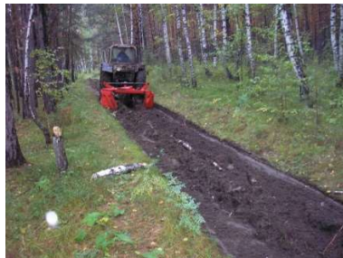
Рис. 2. Работа плуга с дисковыми рабочими органами
