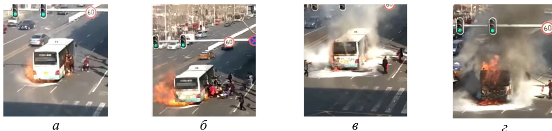
Рис.3. Горение электробуса на маршруте (а – возгорание АБ, б – эвакуация пассажиров, в – тушение, з – догорание электробуса)
