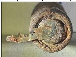
Рис. 12. Фрагмент контактной пластины с прожогом
