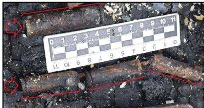
Рис. 11. Три соединенных элемента питания схожего размера (около 14,2x48 мм) и один большего размера (около 18x67 мм), обнаруженные на дне контейнера № 3
