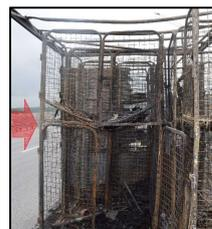
Рис. 5. Наиболее поврежденный контейнер № 3 (отмечен стрелкой) в левой передней части полуприцепа
