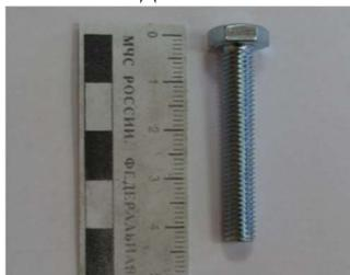
Рис. 1. Внешний вид стальных однотипных болтов марки «WF8.8» до нагрева
