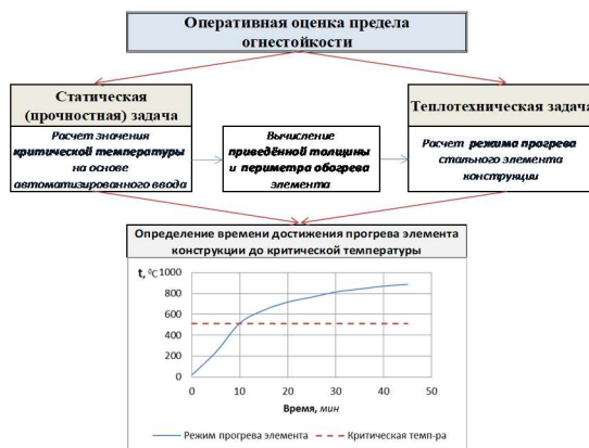
Рис.1 Принципиальный алгоритм оперативной оценки предела огнестойкости
