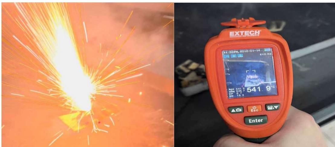
Рис.7. Образец № 2 после механического воздействия на аккумулятор
