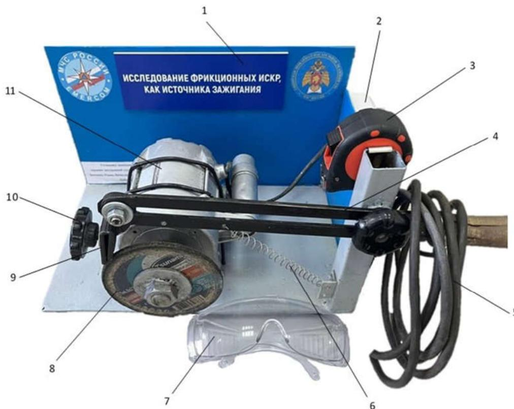
Рис.1. Общий вид лабораторной установки для исследования фрикционных искр где: 1 - основание, 2 - выключатель, 3 - рулетка, 4 - штанга с держателем образца, 5 - провод для подключения к электрической сети, 6 - пружина для натяжения штанги, 8 - абразивный диск, 9 - заменяемая металлическая пластина, 10 - фиксатор пластины, 11 - электродвигатель
