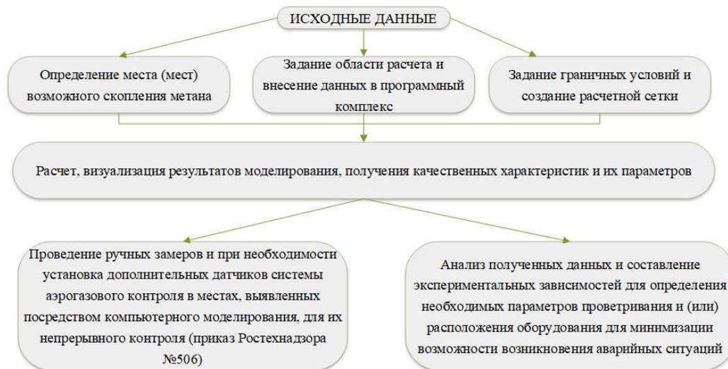
Рис.5. Схема методики последовательных действий УИТП угольной шахты
