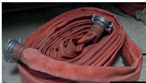
Рис. 2. Места сгибов напорного пожарного рукава: новое ребро – 1 и старое – 2
