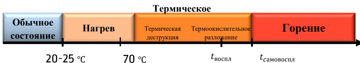
Рис. 1. Условная схема поведения твердых материалов при нагревании
