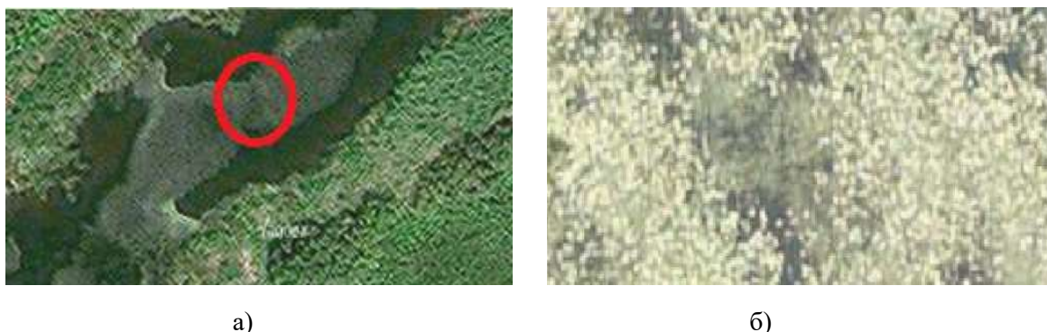
а) б) Рис. 2. Заросли пушицы (растение – индикатор наличия трясины): а) космический снимок, разрешение 10 м; б) снимок, полученный с БПЛА, разрешение 15 см
