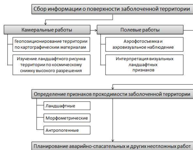
Рис. 1. Основные этапы методики определения проходимости заболоченной территории с использованием данных дистанционного зондирования
