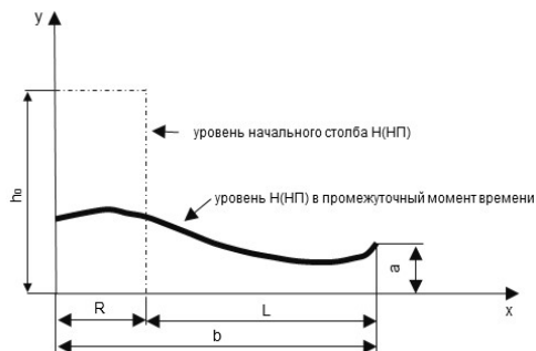
Рис.2. Процесс движения Н(НП) в обваловании резервуара при КМРР
