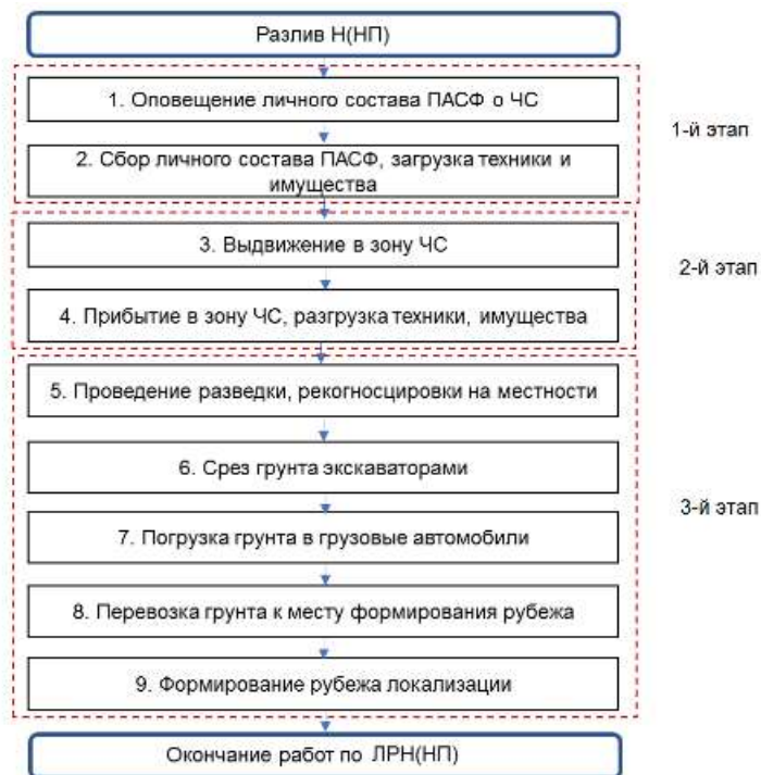
Рис.4. Блок-схема процесса ЛРН(НП) способом построения земляного рубежа
