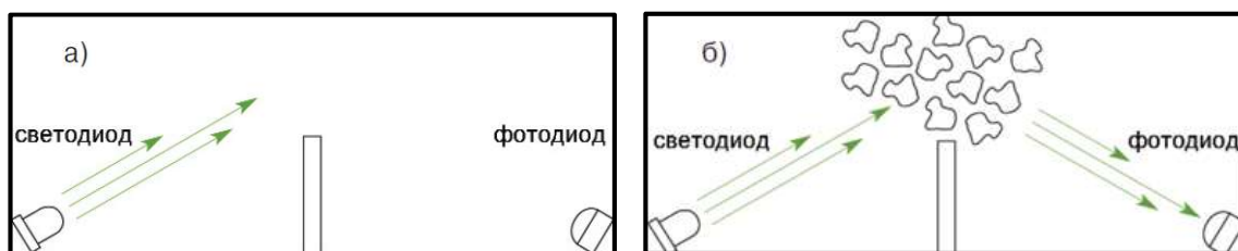
Рис.3. Принцип действия дымового извещателя (а) когда задымления нет, б) появилась мелкодисперсная система)
