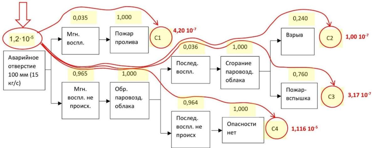
Рис. 6. Последовательность расчёта частоты реализации сценария с помощью логического дерева событий
