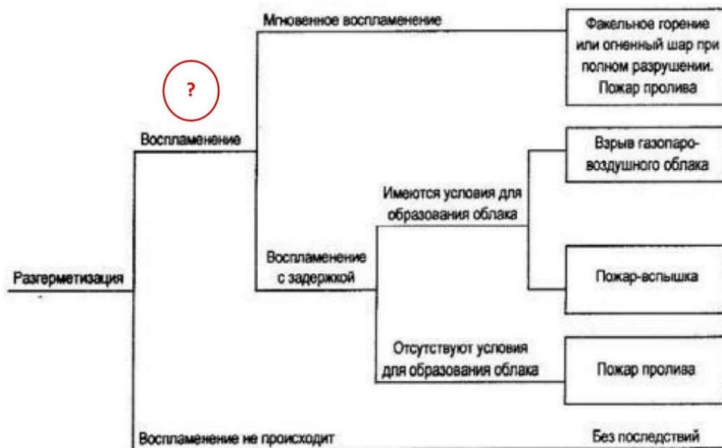
**Рис. П3.2. Типовое дерево событий при возникновении и развитии пожароопасной ситуации, связанной с разгерметизацией единицы технологического оборудования (1-го аппарата) и истечением жидкой фазы или двухфазной смеси СУГ или ЛВЖ**
