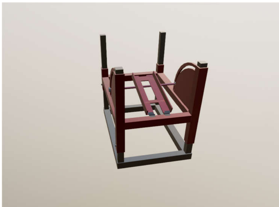
Рис.4. Модель устройства для определения глубины тушения ручных пожарных стволов
