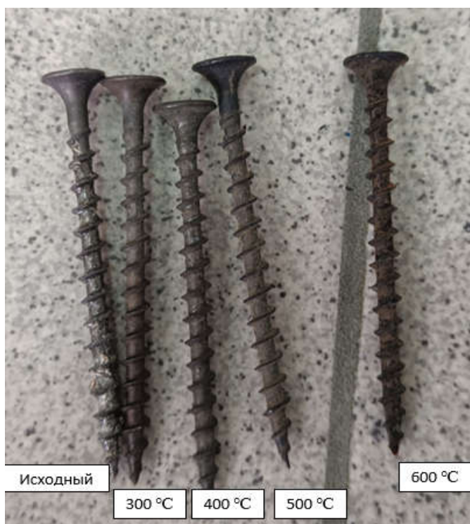
Рис. 5. Образец № 1 после термического воздействия
