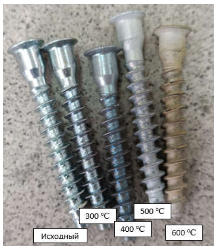
Рис. 7. Образец № 3 после термического воздействия
