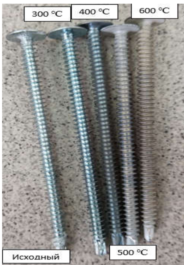
Рис. 9. Образец № 5 после термического воздействия
