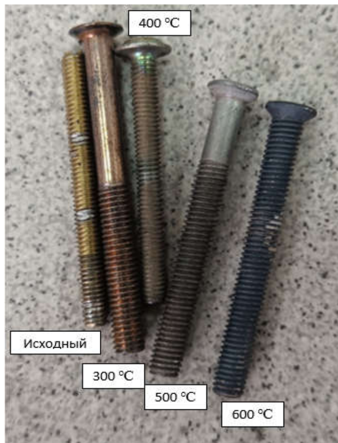
Рис. 6. Образец № 2 после термического воздействия
