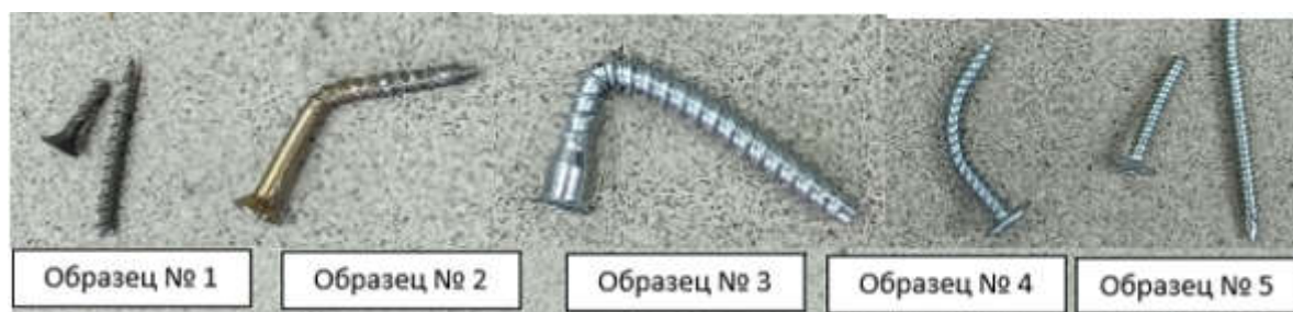
Рис. 2. Выбранные объекты исследования после механического воздействия на излом
