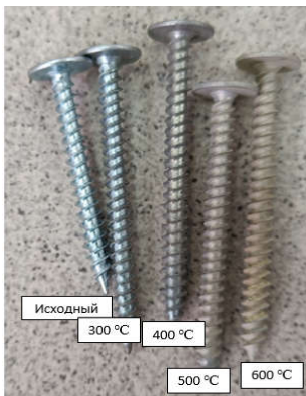
Рис. 8. Образец № 4 после термического воздействия
