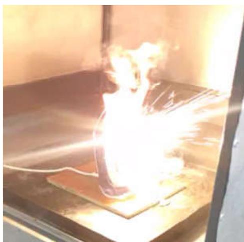
*Рис 8. Горение образца электроутюга*
