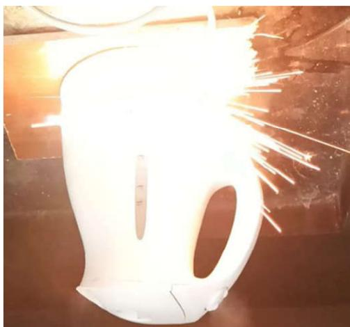
*Рис 9. Признаки короткого замыкания электрочайника*
