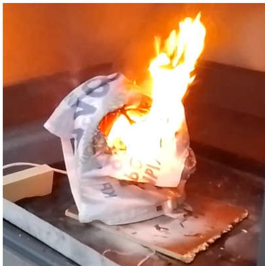
*Рис 9. Пламенное горение тепловентилятора*
