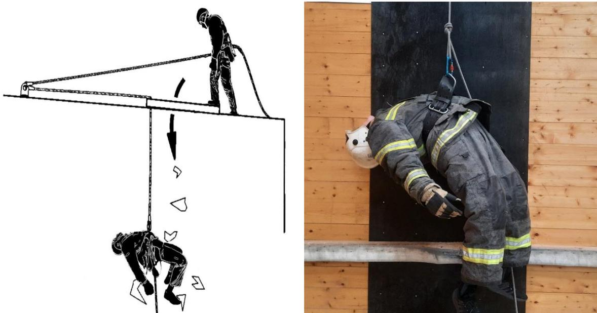
Рис.3. Опасность падения с применением спасательного пояса
