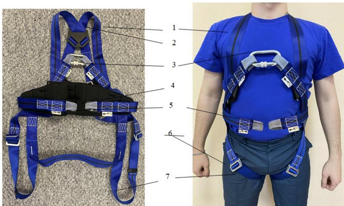
Рис. 4. Компоненты страховочной привязи: 1 – плечевые стропы (лямки); 2 – страховочная точка на спине; 3 – страховочная точка на груди; 4 – широкий пояс (кушак); 5 – брюшная точка крепления; 6 – регулировочные пряжки; 7 – набедренные стропы (лямки);
