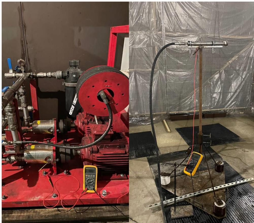
*Рис.4. Места измерения тока утечки во время экспериментального исследования*
