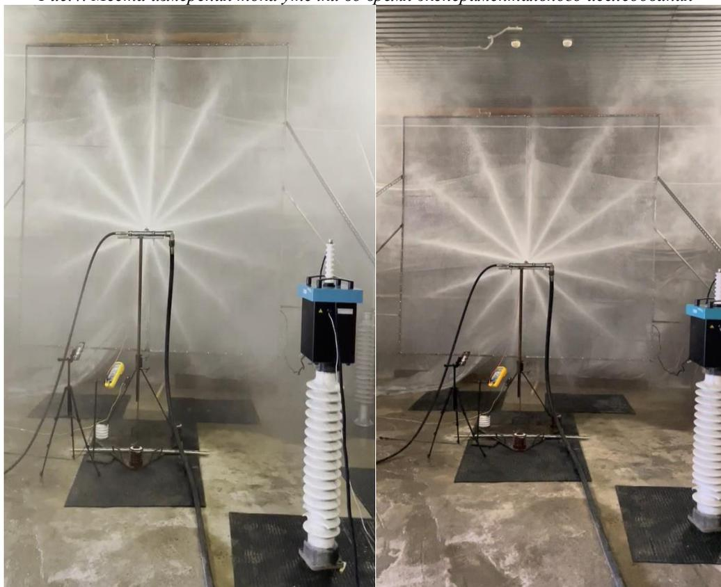
*Рис.5. Экспериментальное исследование величины тока утечки из АУПТ*
