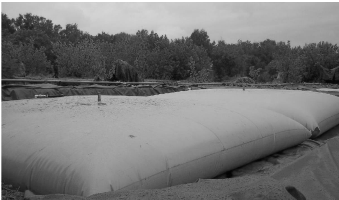
Рис.1. Эластичный полимерный резервуар ПЭР-100Н (для дизельного топлива)
