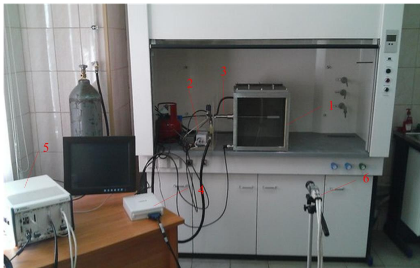
Рис.5. Лабораторная установка: 1 - взрывная камера, 2 - устройство для подачи газа, 3 - искровой источник зажигания, 4- терминальный блок NISCC-68, 5- вычислительный контроллер управления и сбора данных NIPXI-8133, 6 - цифровая высокоскоростная камера Basler acA2000-340km (до1400 кадров/с), 7 - датчики давления Hjneywell Astop MA, 8 – вольфрамрениевые микротермомпары
