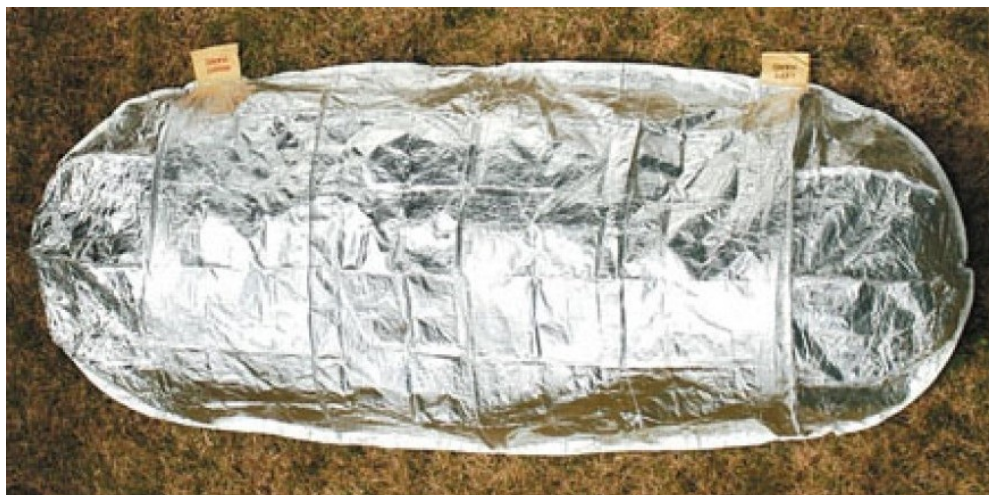
Рис.1. Средство защиты людей от повышенных тепловых нагрузок «Fire Shelter» в условиях природных пожаров [11]
