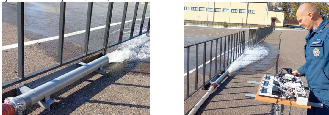
Рис.5. Фрагмент проведения испытаний Устройства, разработанного для обеспечения безопасности исследователей и сохранности приборов и пожарной техники при проведении гидравлических исследований по определению значений параметров элементов НРС
