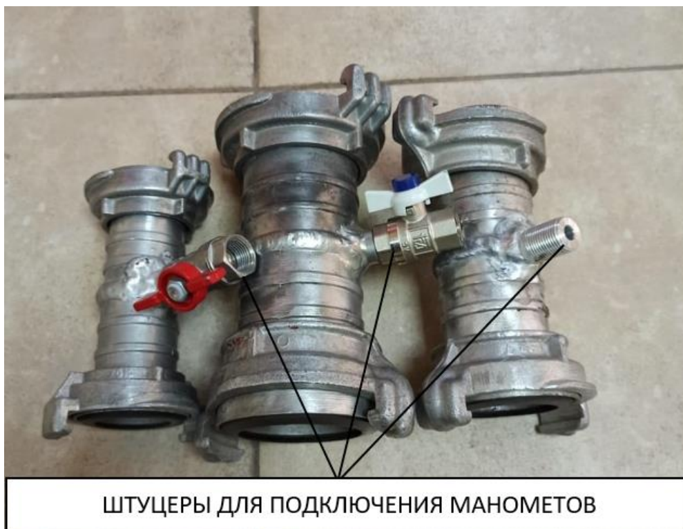
Рис.2. Вставки со штуцерами для подключения электронного манометра, позволяющего проводить измерения давления непосредственно перед (после) исследуемого элемента НРС
