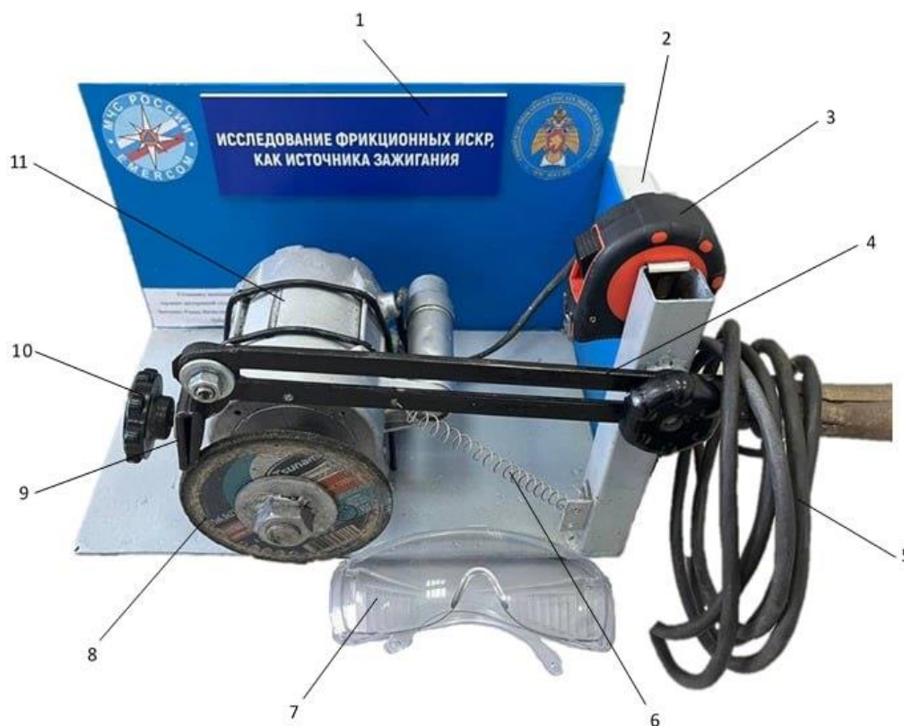
Рис.1. Общий вид лабораторной установки для исследования фрикционных искр где: 1 - основание, 2 - выключатель, 3 - рулетка, 4 - штанга с держателем образца, 5 - провод для подключения к электрической сети, 6 - пружина для натяжения штанги, 8 - абразивный диск, 9 - заменяемая металлическая пластина, 10 - фиксатор пластины, 11 - электродвигатель
